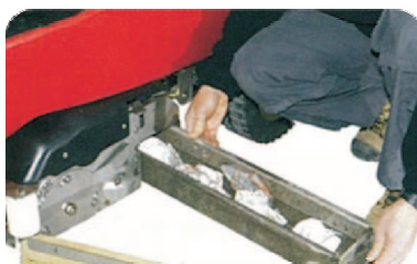
Kehr-Walzenschrubbaggreat mit Grobschmutzsammelbehälter
