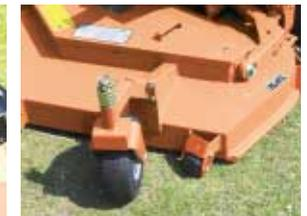
Die Mähwerke sind verstärkt und die Räder mit durchschlagsicherem Schaum gefüllt.
