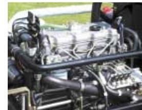
Der neue 2,2 Liter Turbomotor Perkins 404C-22 bietet höhere Leistung und ein größeres Drehmoment bei reduziertem Geräuschniveau und weniger Schwingungen.
