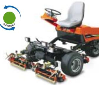
Ein vollelektrischer Triplex-Greens-Mäher mit leisem, abgasfreien Schnitt für feines Gras.
