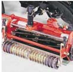
Präzisionszylinder für einen Schnitt in Turnierqualität.
