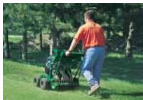
**In einem Durchgang: Entfilzen und Nachsäen**
