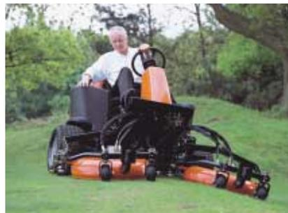
Dem Boden folgende abgesetzte Mähwerk-/ Schneidzylinderkonfiguration mit Tendenz zum Linksauswurf und einem Überstand von mehr als 175 mm, was ideal für das Mähen von Bunkerrändern ist.
