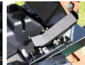
Schaltpedal zur Umschaltung zwischen Transport- und Mähgeschwindigkeit.
