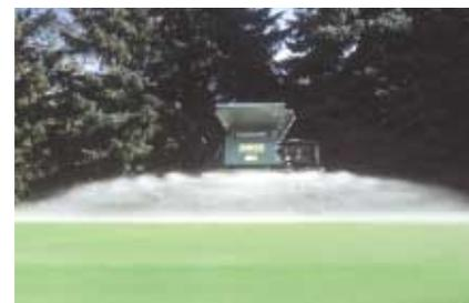
Ein paar einfache Halterungen und Anschlüsse und ein Turf Truck wird zu einem Düngestreuer.
