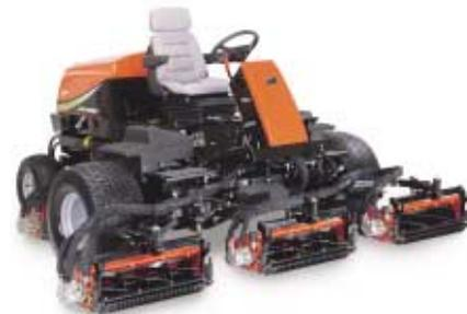
Mäher mittleren Gewichts mit 5 Einheiten und 4-Radantrieb für unübertroffene Produktivität
