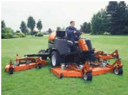
Der große Rasenmäher für einen 4,88 m breiten Qualitätsschnitt und hervorragende Produktivität. Alle hydraulischen Mähwerke mit rückwärtigem Auswurf.
